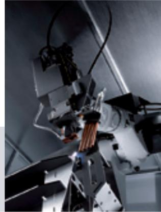
Blechen verbinden; somit muss die große Masse nur an die Stellen, wo sie wirklich nötig ist. Beim Tragwerk für den SheetMaster erlaubte das Tiefschweißen mittels Laser den Einsatz von weniger und dünneren Blechen. Das drückte das Gewicht um 25 Prozent und – insbesondere durch das Entfallen sämtlicher Richtarbeiten – die Kosten um 60 Prozent nach unten. Höhere Präzision und weniger Verzug minimierten zudem den Aufwand für das Fräsen, da die Flächen nur noch leicht überfräst werden müssen.
